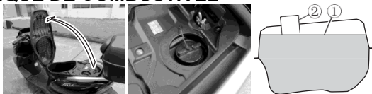
1.Nível de combustível 2.Bocal de abastecimento
