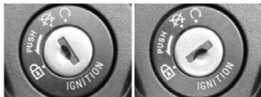
NOTA: Somente quando o orifício da chave estiver nas duas posições ilustradas acima a chave poderá ser completamente inserida, retirada ou virada e então a ignição poderá ser efetuada, trancada ou destrancada. Se a chave for inserida parcialmente no orifício da ignição, a chave poderá ser virada em qualquer posição; contudo, a chave não pode ser completamente inserida dentro da ignição e nenhuma função poderá ser realizada.
