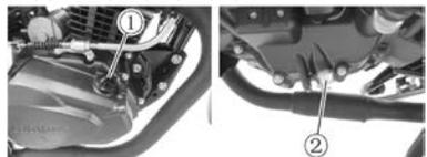
Troque o óleo do motor com o novo óleo depois de o motor estar quente para drenar completamente o óleo anterior. Siga os passos para a troca de óleo do motor.
