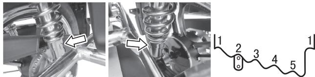
A pré-carga da mola do amortecedor traseiro é ajustável para compensar o piloto, a carga, o estilo de direção e as condições da estrada. A pré-carga da mola é ajustável em cinco posições. Gire o anel de tensão da mola para a posição desejada com o ajustador da mola. A posição 1 fornece a tensão de mola mais suave e a posição 5 fornece a mais rigidez. Esta motocicleta é entregue de fábrica com seu ajustador na posição 2
