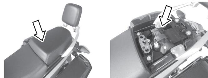
O kit de ferramentas está abaixo da saddle. Ele pode ser visto depois que a trava da sela é aberta e a sela é removida. Ele pode ser retirado após o cinto de fixação ser afrouxado.
