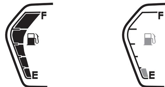
O medidor de combustível exibe 5 segmentos. o medidor de combustível exibe todos os 5 segmentos quando o tanque de combustível está cheio. Quando 1 segmento e o indicador de posição inferior de combustível piscarem 8 ao mesmo tempo, agora, o tanque tem 2 litros de combustível, você deve reabastecer o mais rápido possível.
