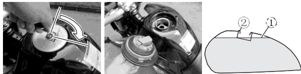
1 Nível de combustível 2 Bocal de abastecimento
